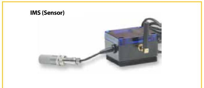
**IMS:** Der drahtlose Sensor IMS misst Temperatur und Feuchtigkeit im Raum und kommuniziert mit der IMC-Einheit.
